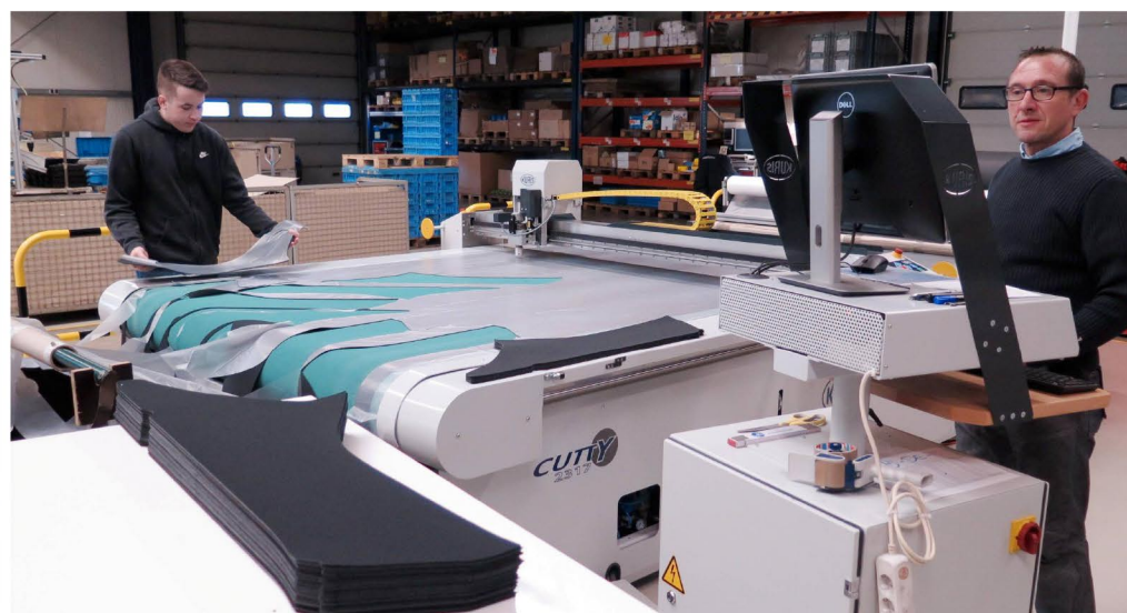
Computergesteuert werden Kunstlederstücke für Auto-Armaturenblecher zugeschnitten. Foto: Jansen
